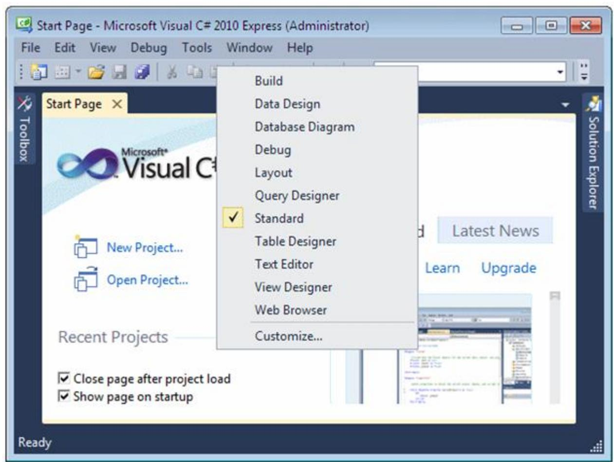
فهرست ها و نوار ابزارهای Microsoft Visual Studio را می توان مطابق میل تنظیم (customize) کرد. می توان با اضافه کردن یک menu item به فهرست گزینه، آن را مطابق میل تنظیم کرد یا با اضافه کردن تنها یک دکمه به نوار ابزار، آن را (سفرارشی) تغییر داد. برای شروع، روی هر گزینه ای (در main menu یا Start) راست کلیک کرده، سپس گزینه customize را انتخاب کنید. می خواهیم آیتمی به نام toolbar را به سمت چپ Start button without debugging اضافه کنیم.
